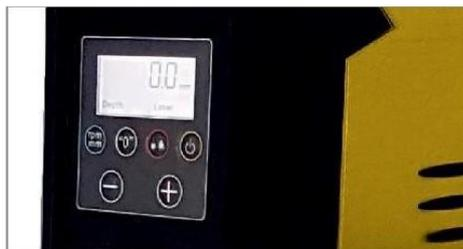
Display digital indicador de velocidad y profundidad de perforación
